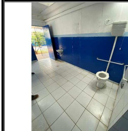
Imagem 03: vaso sanitário (faltando a tampa), 1 pia, 1 ralo, piso cerâmico, paredes OK.
