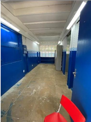
Imagem 01: 1 janela dupla de madeira com vidro, piso em placas de concreto, 6 luminárias duplas.
